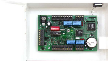
Řídicí jednotka AL40, pro připojení maximálně 4 snímačů identifikačních médií
